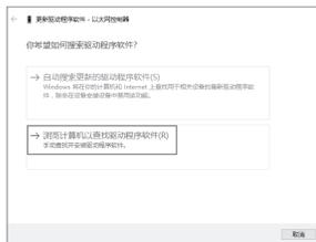
4. 点击“浏览”，在官网下载的驱动程序软件里选取对应系统的驱动，点击“下一步”。
